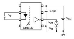
Fig. 12.1.1 I<sub>OH</sub> Test Circuit
